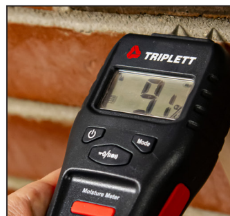
Moisture Meter (pin)
