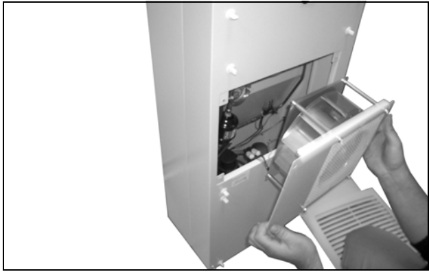
Fig. 68: Remove the external circuit fan
